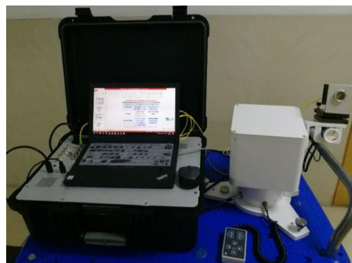
左：研发的高精度本底 CO 2 /CH 4 浓度分析仪； 右：研发的温室气体廓线分析仪
